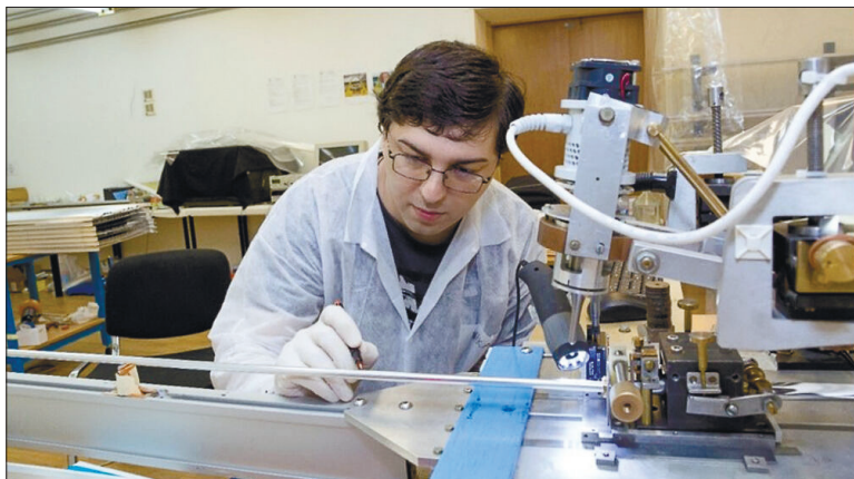
Николози Цверава (ЛЯП) за производством майларовых трубочек на установке в ЛФВЭ
