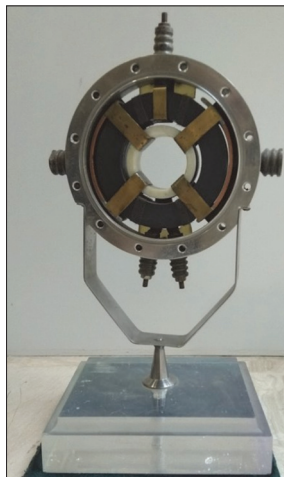
Часть устройства для синтеза трансурановых элементов, с помощью которого были получены 102-й и 103-й элементы
