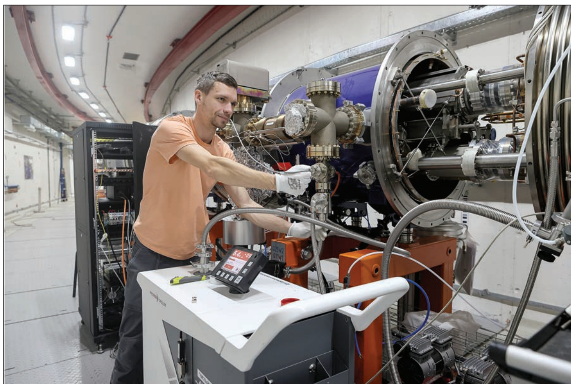
Лаборатория физики высоких энергий им. В. И. Векслера и А. М. Балдина. Проверка герметичности пучковой камеры коллайдера
