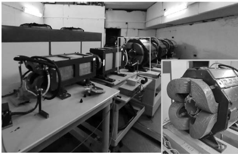
Рис. 3. Зона вывода пучка из ускорителя У-70 в 25-й канал. Активационный детектор размещен после линзы Q7
